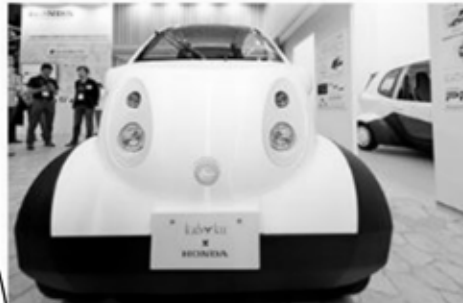
3Dプリンタを使って作られたボディのパーツは全部で200個ほど ホンダのHPより
