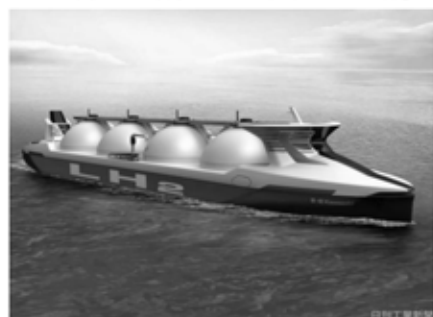
川崎重工が研究を進める液化水素運搬船 川崎重工株式会社 水素プロジェクト特設サイトより
