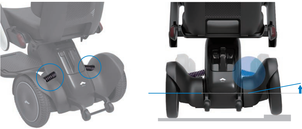
後輪のサスペンションにより、でこぼこ道や段差乗り越えの衝撃を吸収。 長時間走ってもストレスを感じません。
