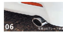
06 LXマフラーカッター 光沢感のあるバフ仕上げのマフラーカッター。純正マフラーにボルトにて固定。
